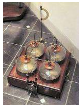
Рисунок 2. Лейденская банка. Параллельное соединение четырёх банок
