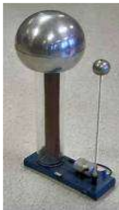
Рисунок 1. Электрическая машина фон Герике, усовершенствованная Ван де Графом
